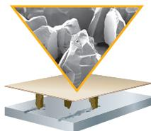
En effet, les abrasifs conventionnels dont le grain est en céramique ont tendance à « ciseler » le métal, ce qui crée de la chaleur dans la pièce et l'abrasif. La coupe est donc moins rapide et le disque de tronçonnage dure moins longtemps.
